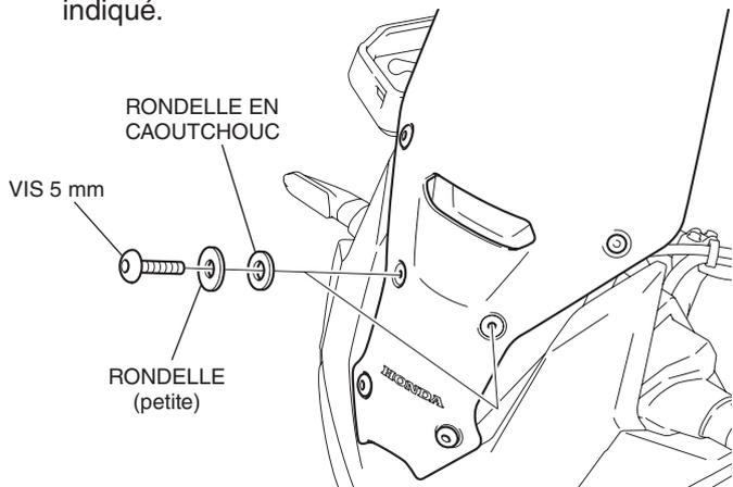
9. Serrez à fond les pièces partiellement serrées.
